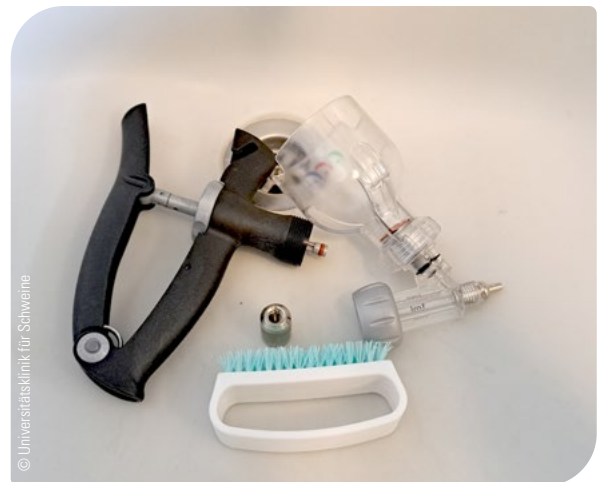
Abb. 7: Zerlegte Impfpistole für Reinigung und Desinfektion
